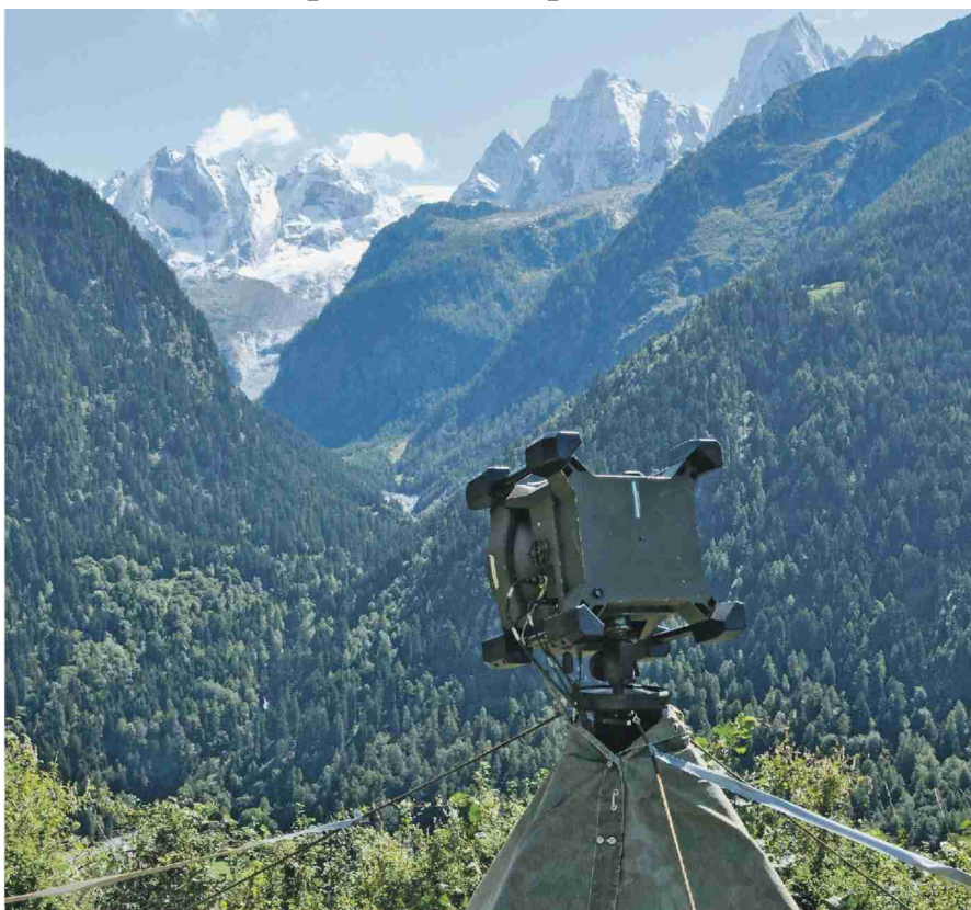
Mit Richtfunkgeräten der Schweizer Armee wird die Kommunikation im Krisengebiet sichergestellt. Foto: Marie-Claire Jur
