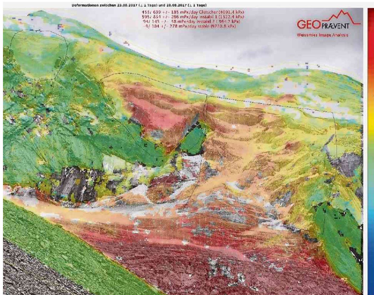
Solche Bilder lieferte die Kamera am Triftgletscher ob Saas-Grund: Je mehr Rot, desto mehr Bewegung. GEOPRAEVENT
