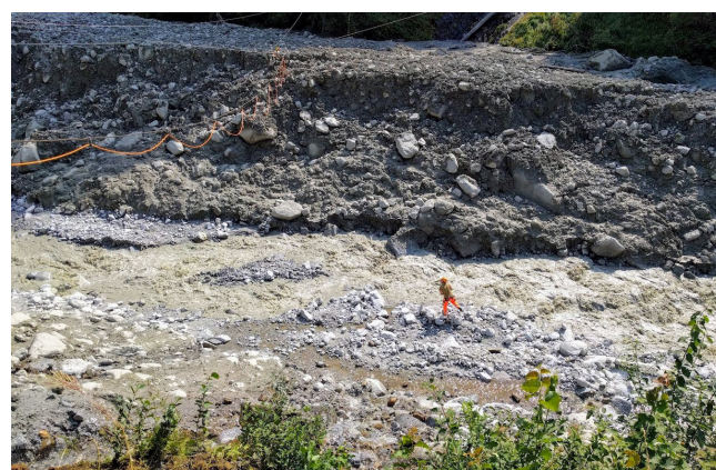
Figure 3 : Radar de niveau (station A) au-dessus de la Bondasca avec plusieurs mètres de gravats dus aux événements d'août et de septembre 2017.
