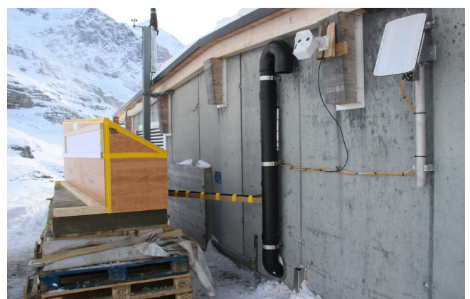
Abbildung 3: Das interferometrische Georadar ist gut geschützt in der Holzkiste. Daneben schauen Kamera und Lawinenradar zum Gletscher.
