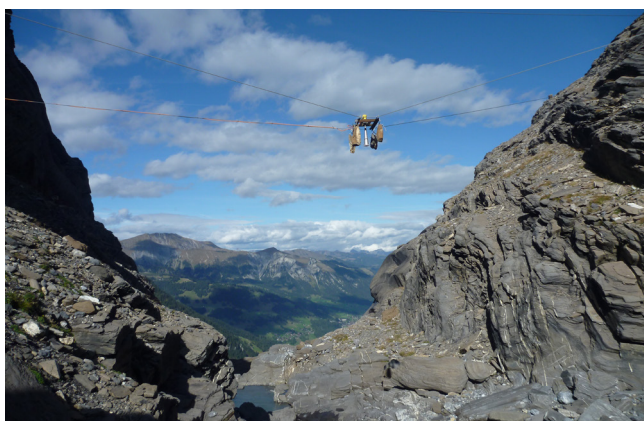
Abbildung 2: Der Pegelradar überwacht den Abfluss des Gletscherplateaus am Trüebbach. Dieser ist ein Zufluss der Simme, die durch das Dorf Lenk fliesst.
