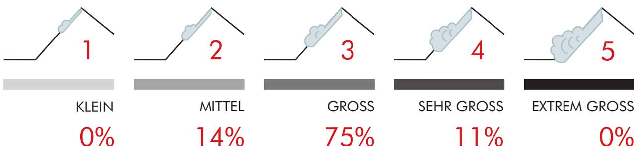
Das Radar erkennt das Ausmass der Lawine und ordnet ihr automatisch eine Grösse zwischen 1 und 5 zu. Dies ist eine grobe Abschätzung und hängt zudem von der Exposition der Lawine ab.
