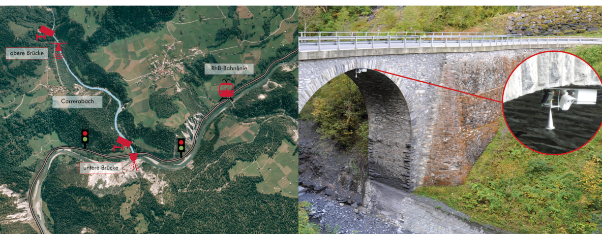
Titelbild: Die Alarmanlage von Geopraevent überwacht die RhB-Bahnlinie bei der Einmündung des Carrerabaches in den Vorderrhein.
