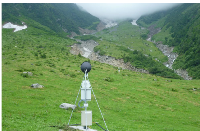
Abbildung 2: Mit einem Doppler-Radar wird der Graben weiter oben beobachtet.
