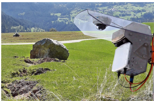
Abbildung 2: Das Steinschlagradar detektiert fallende Felsbrocken und aktiviert automatisch eine Webcam, welche das Ereignis aufzeichnet.
