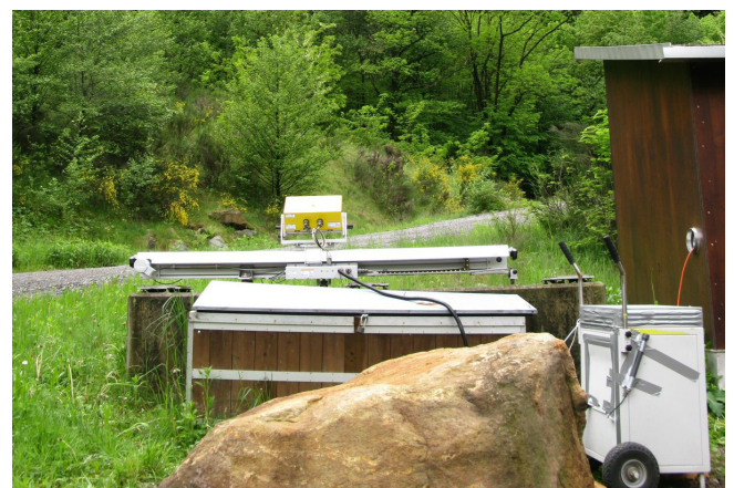
Abbildung 3: Das interferometrische Radar steht in einer Entfernung von ca. 2 km Luftlinie.
