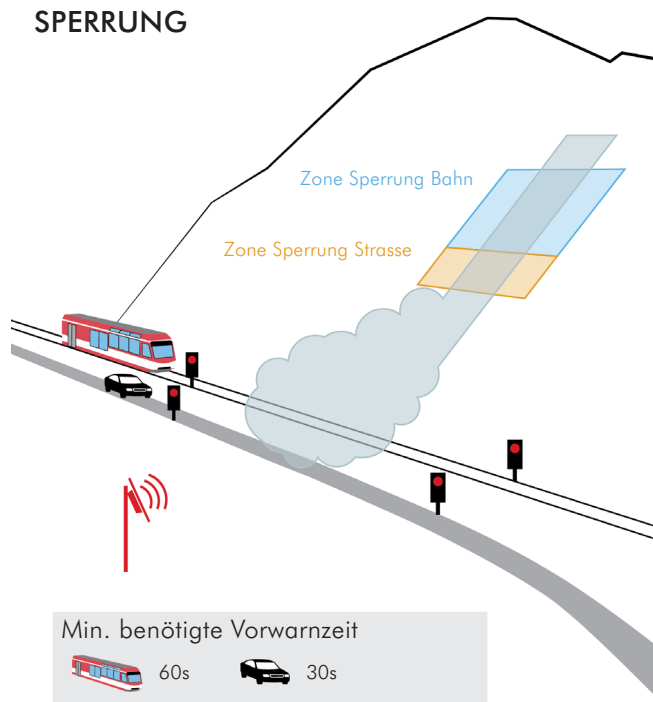
Abbildung 4: Schematische Darstellung der automatischen Sperrung von Strasse und Bahn.
