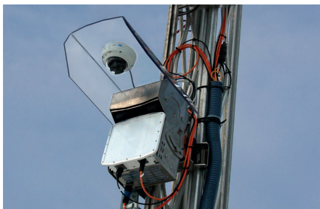
Abbildung 2: Das Lawinenradar detektiert zuverlässig Lawinen bei jedem Wetter und zu jeder Tageszeit und löst die Kamera aus.
