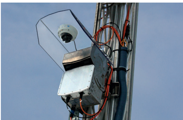
Abbildung 2: Das Lawinenradar detektiert zuverlässig Lawinen bei jedem Wetter und zu jeder Tageszeit und löst die Kamera aus.
