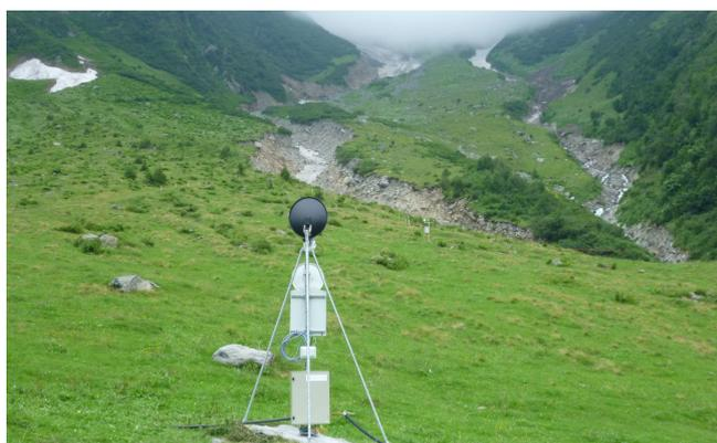
Figure 2 : Un radar Doppler détecte les mouvements dans la partie supérieure de la tranchée.
