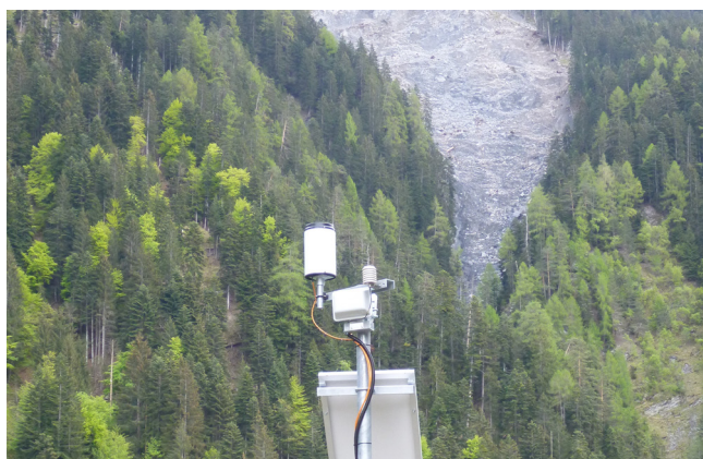
Abbildung 2: Die installierte Wetterstation liefert lokale Daten zu Niederschlag und Temperatur, was für die Murgangprognosen von Wichtigkeit ist.
