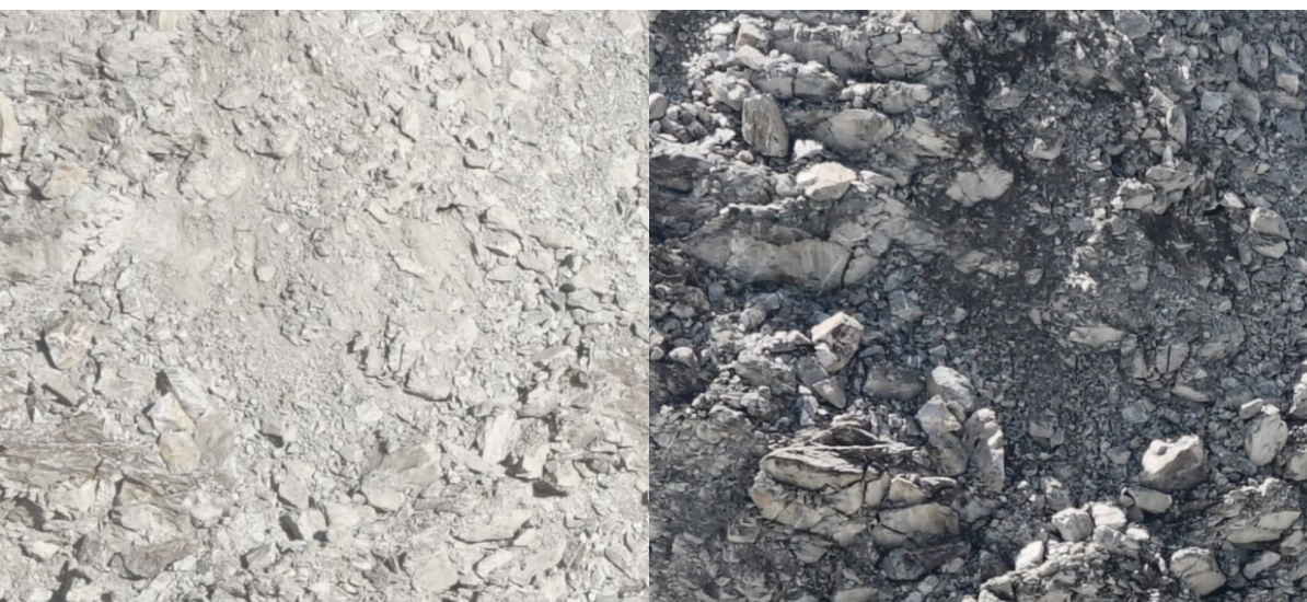
Figure 4 : La même section d'image à gauche (8 heures) et à droite (12 heures) avec des conditions de lumière et d'ombre différentes. Des algorithmes d'évaluation automatique distinguent indépendamment les déplacements et les changements de lumière.
