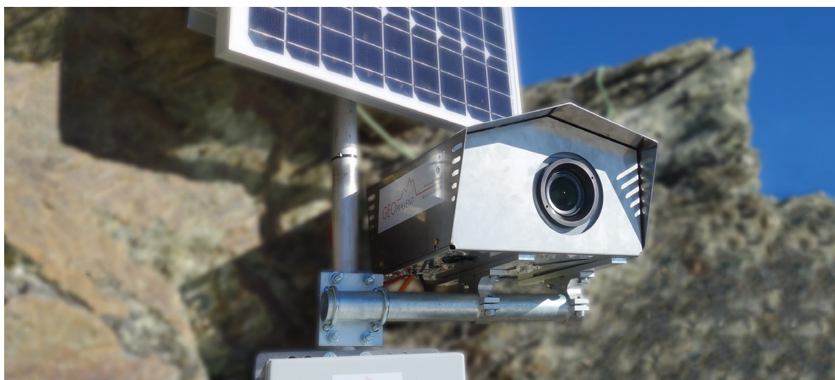
Figure 8 : Installation en haute altitude de la caméra DEFOX® PRO pour la surveillance à long terme du glacier suspendu du Weisshorn. Le système, situé à 4133 m d'altitude, fonctionne toute l'année.
