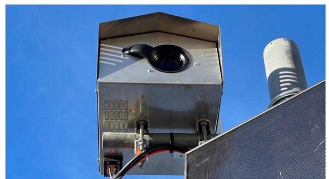
Abbildung 3: Kamera mit dem Laubbläser im Bereich des Objektivs und einem Solarpanel.
