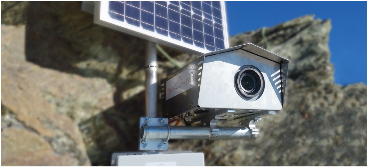
Figura 8: Instalación de alta alpinidad de la cámara DEFOX® PRO para el monitoreo a largo plazo del glaciar colgante Weisshorn. El sistema a 4133 m.s.n.m. funciona durante todo el año.
