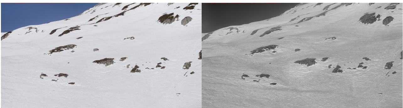
Die SNOFOX PRO-Kamera (rechtes Bild) bietet eine bessere Sichtbarkeit mit hohem Kontrast bei starker Sonneneinstrahlung oder Verschattung. Die Oberflächenstrukturen lassen sich dadurch besser erkennen als bei der Aufnahme mit der PROCam.
