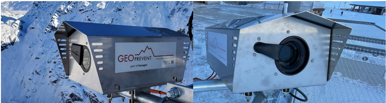
Blower – Clear Lens System: Gebläsesystem von GEOPREVENT entwickelt.
